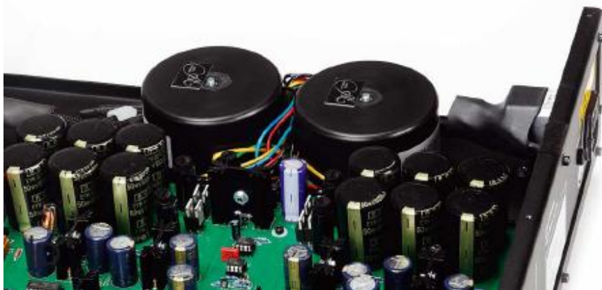
Mehr als ausreichend Siebkapazität bietet das kanalgetrennt aufgebaute Netzteil der P2
