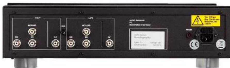
Für eine Phonostufe gibt es recht viele Anschlüsse – die oberen Buchsen dienen dem Einstecken zusätzlicher angepasster Eingangswiderstände
